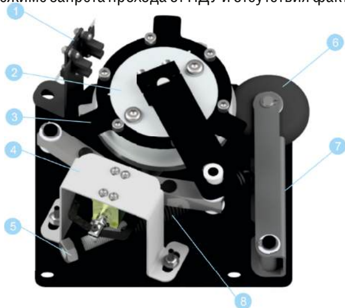
Рисунок 6.2.1. – Устройство механизма турникета
