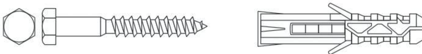
Рисунок 7.4.1 – Шуруп с шестигранной головкой «Глухарь» с дюбелем
