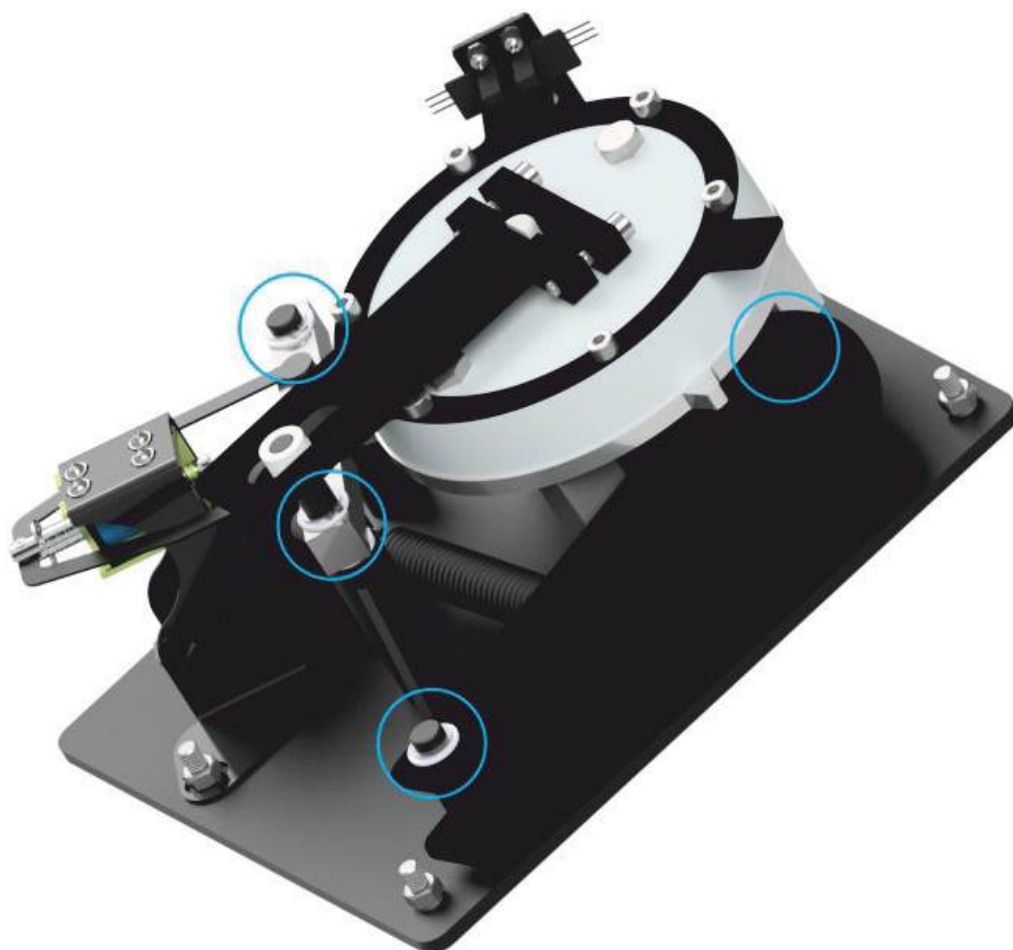
Рисунок 12.5.1 – Места смазки подвижных частей
