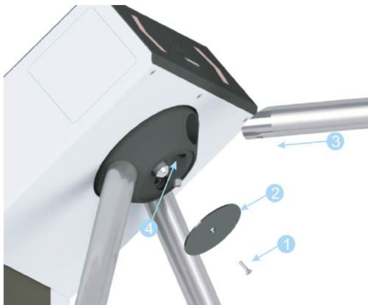
Рисунок 7.5.1 – Установка стандартной преграждающей планки
